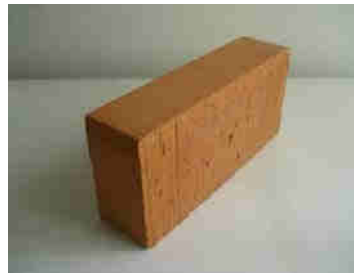
Figura 15.1 - Esempio di mattone pieno \emptyset \leq 15\% in laterizio per murature portanti
