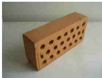
Figura 15.2 - Esempio di mattone semipieno 15\% < \emptyset \leq 45\% in laterizio per murature portanti
